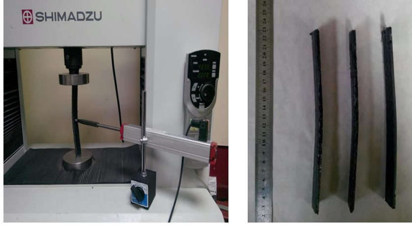
Şekil 6. GFRP takviyeli numunelerde burkulma deneyi
